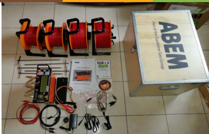
Figura 2. Resistivímetro ABEM SAS 1000, para el levantamiento de la tomografía de resistividad eléctrica. Fuente: Equipo propio utilizado.
